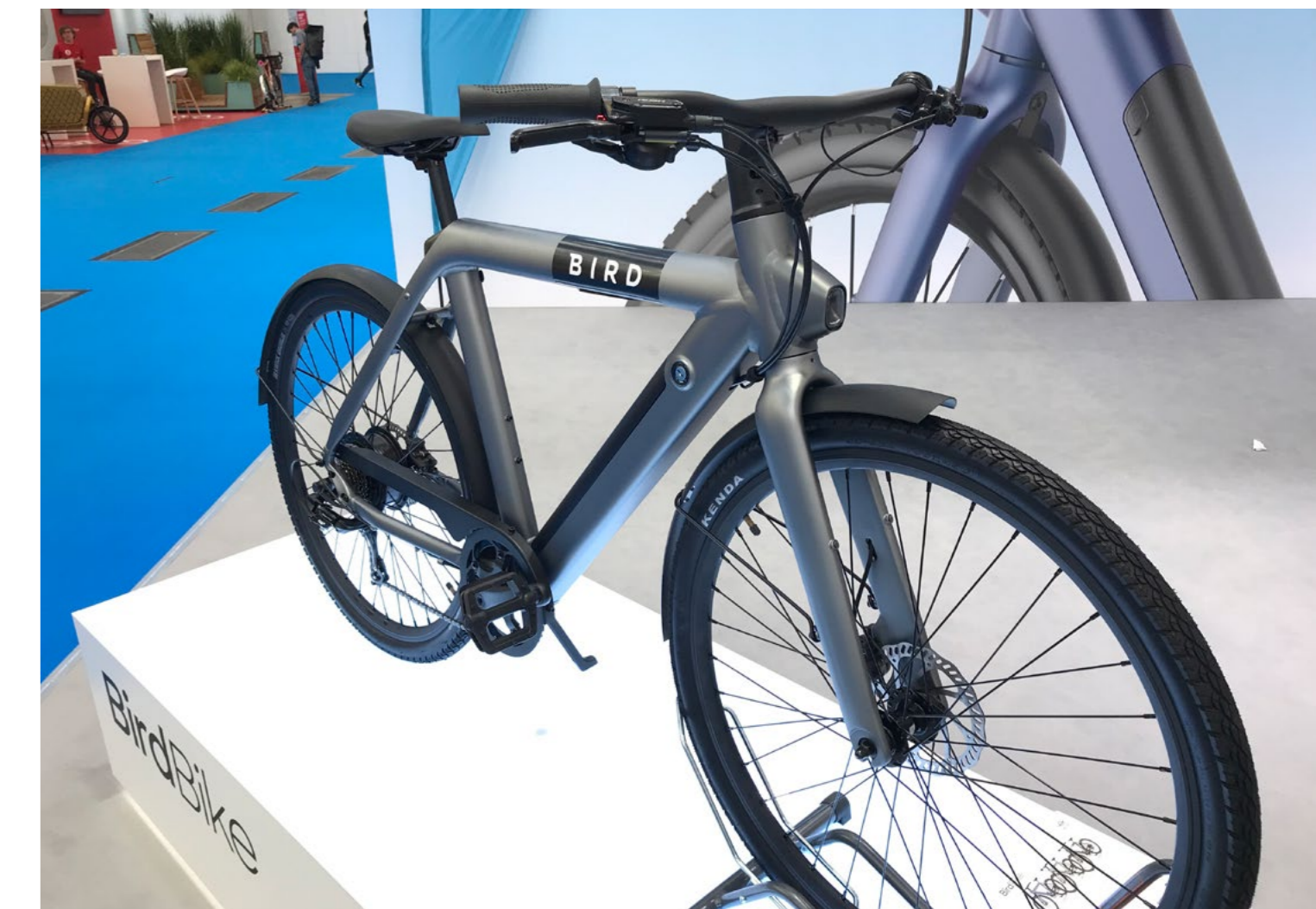
Abb. 2: Bird Bike Front und Rückleuchte sowie die Batterie sind im Rahmen eingebaut, um Diebstahl zu erschweren. Das digitale Bedienelement ist in den Vorbau integriert.
