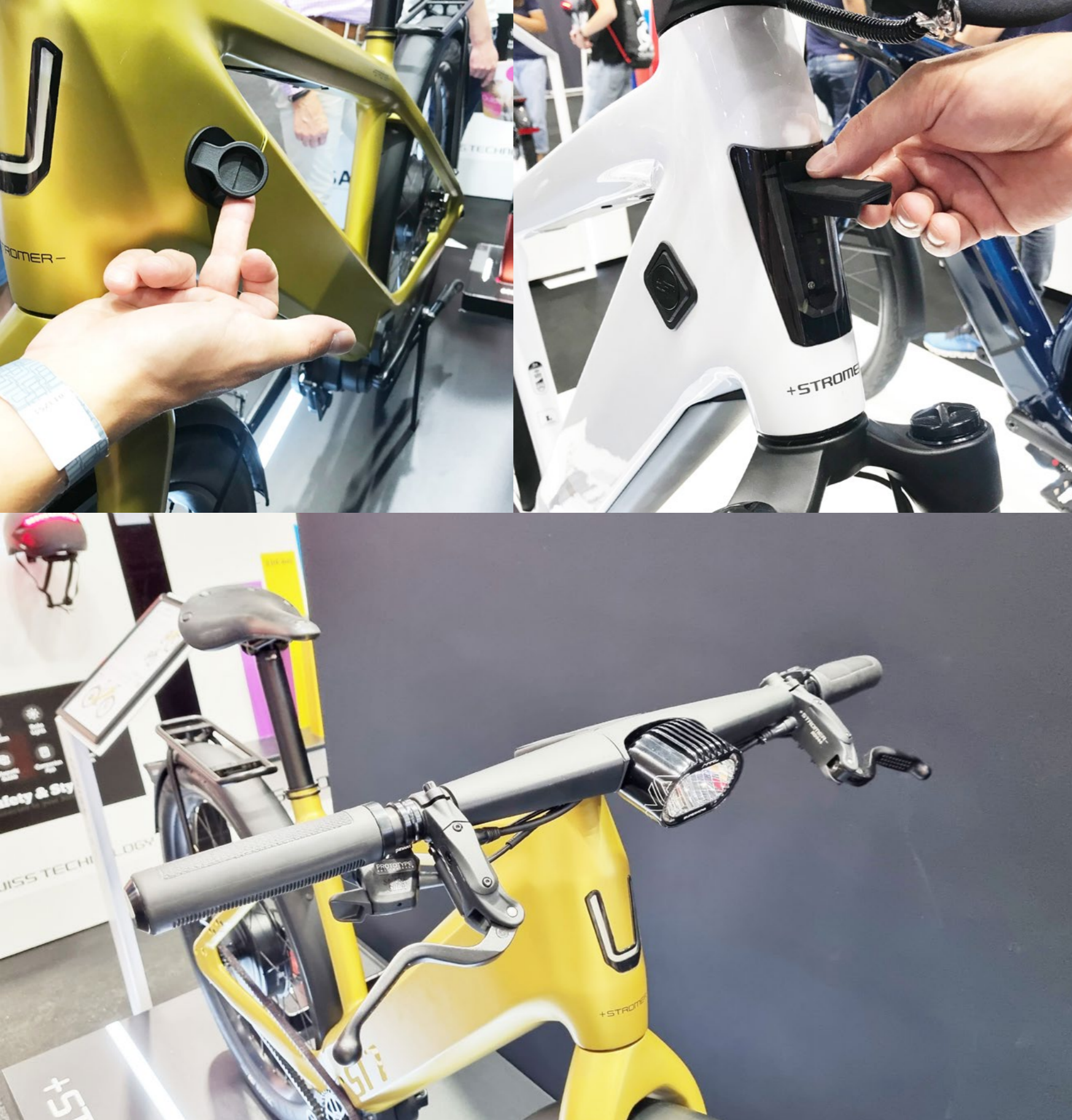
Abb. 3: Stromer, myStromer AG Komponenten sind hochgradig integriert, einige Komponenten können gleichzeitig als Ladebuchse oder als Handgriff genutzt werden. Foto: Culture Form GmbH
