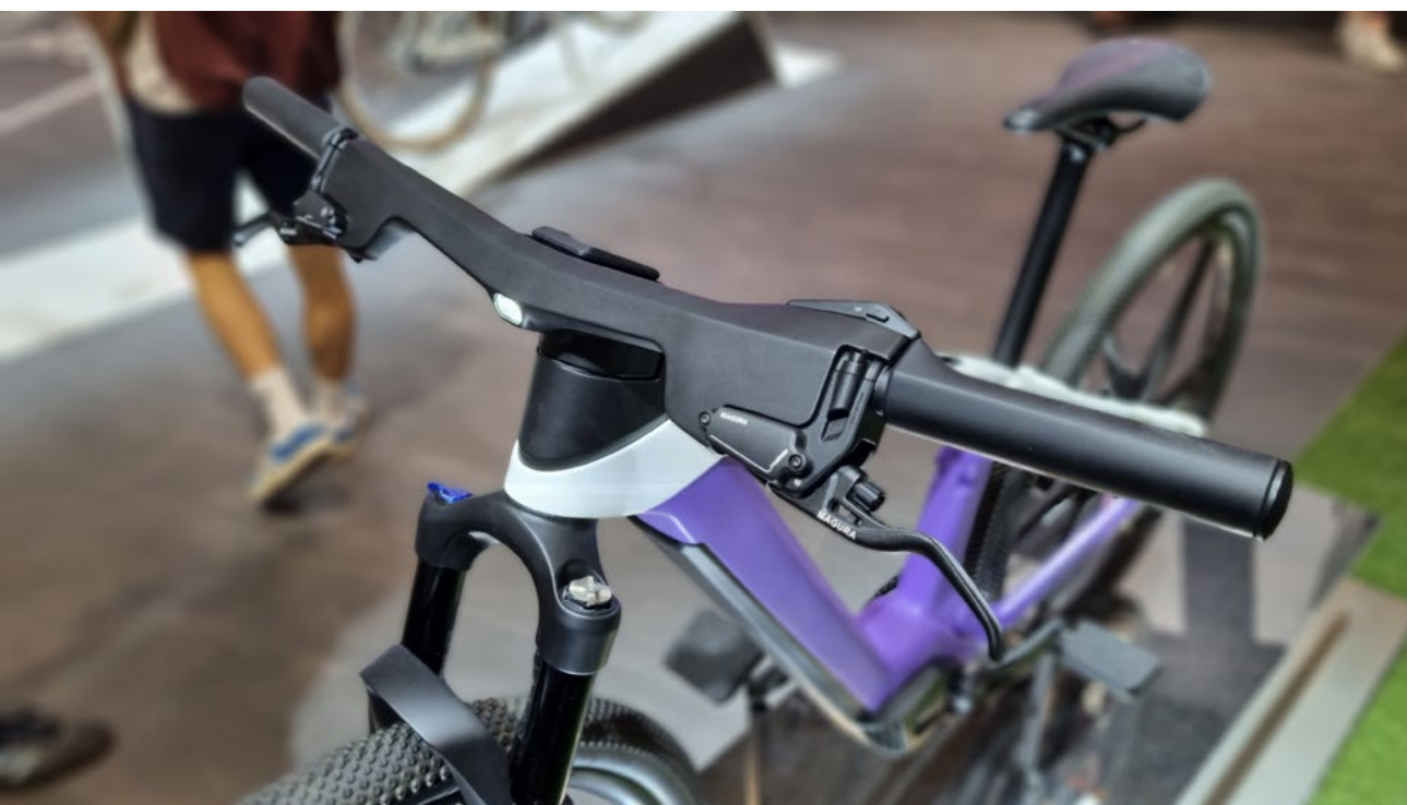
Abb. 1: Bosch Design Vision Bike Bremsen, Lenkergriffe, Bordcomputer und die Frontleuchte sind in den Lenker integriert. Die Hinterradfederung und der Federdämpfer sind im Rahmen untergebracht.
